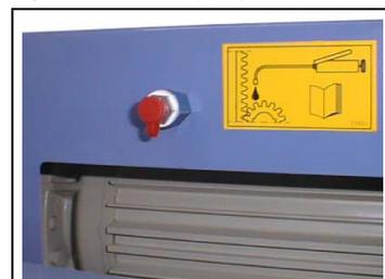
Fig. 33 Zahnstange schmieren
