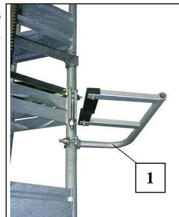
Fig. 26 Schleppkabelführung
